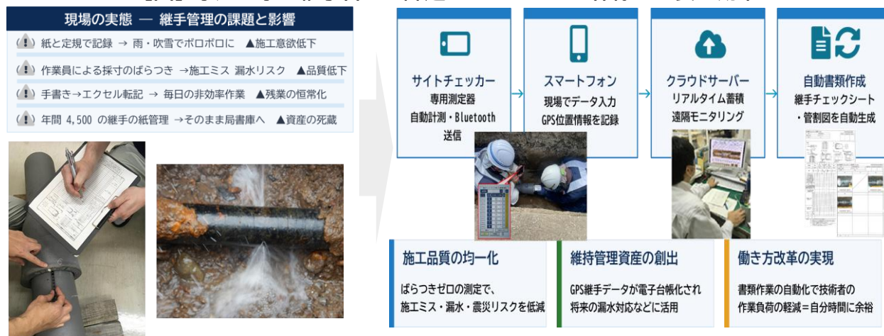
【図】水道工事の継手管理の課題とシステムの全体像と主要な効果
