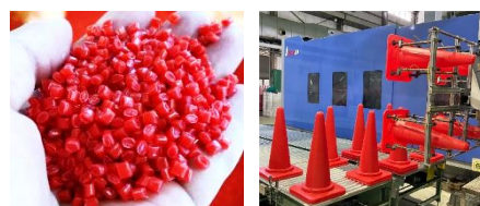
ペレット製造 射出成形 図 1 製造状況
