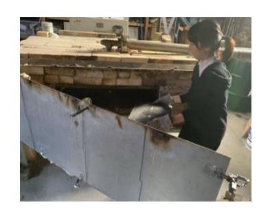
「環境に良いと思って販売してきたソーラーパネルが、環境を 汚す廃棄物になってしまうのは耐えられない。ソーラーパネル メーカーとして最後まで責任を持ちたい」と考え、2017年より 試行錯誤を繰り返し、2019年に世界で初めて、使用済ソーラー パネルからCO2を排出せずに高純度マテリアル(ガラス・太陽 電池セル・インターコネクタ)を分解抽出できる『佐久本式 ソーラーパネル熱分解装置』(バッチ機)を開発しました。
